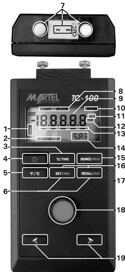
(8) 原始/測定モード指示器 (SOURCE/MEASURE MODE INDICATOR)
