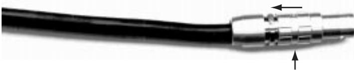
*Figure 9a. Power Connector release*
